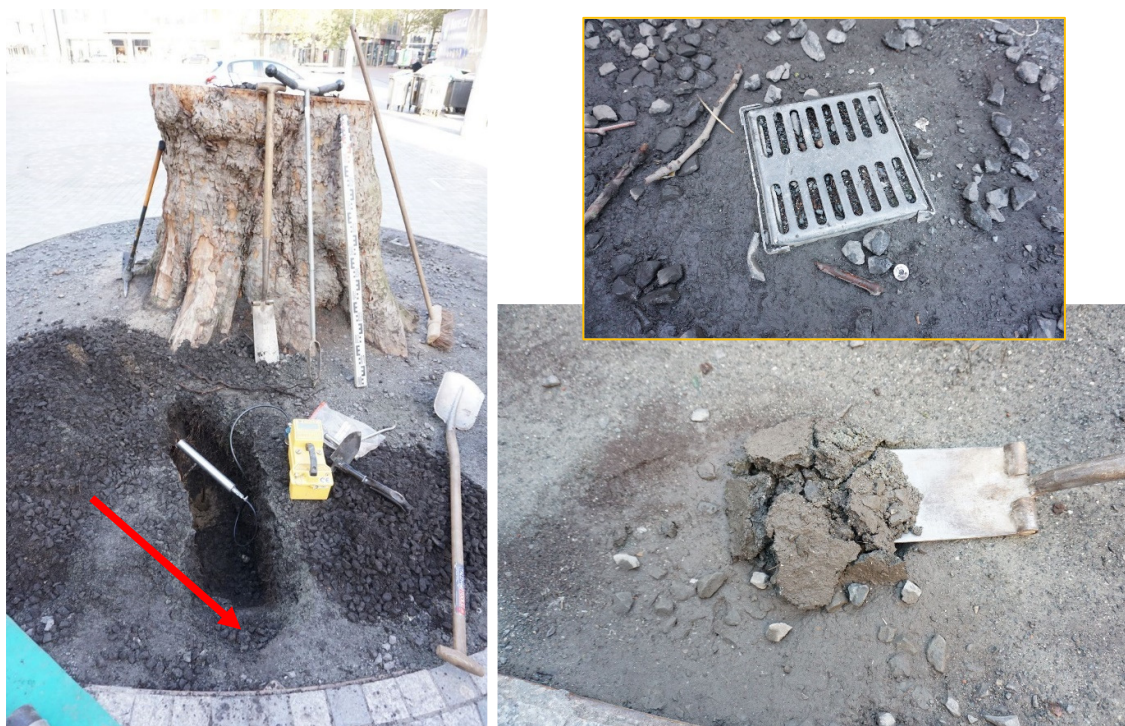
Foto 2 en 3: Beeld van profielkuil bij de stobbe van de gewone platan met boomnummer 1924618 (links) en beeld van de verslechte bovenlaag / halfverharding (rechts). De rode pijl geeft de ligging van Geotextiel weer.
